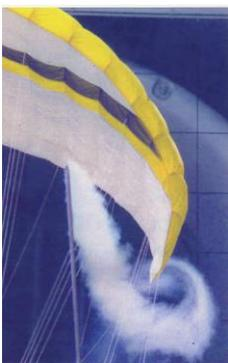
Alle auftriebserzeugenden Teile erzeugen neben dem Formwiderstand auch Randwiderstand. Die durch den Auftrieb verursachten (induzieren heißt: herbeiführen, verursachen) Druckunterschiede zwischen Flügelober- und Flügelunterseite gleichen sich an den Flügelenden aus und bilden widerstandsreiche Wirbelzöpfe. Gleichzeitig gehen dabei die äußeren Flügelteile für die Auftriebserzeugung verloren.
